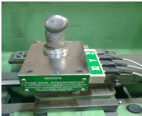
Fig. 3 Lathe Tool dynamometer
