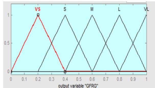
Fig. 3: fuzzification of output parameter
