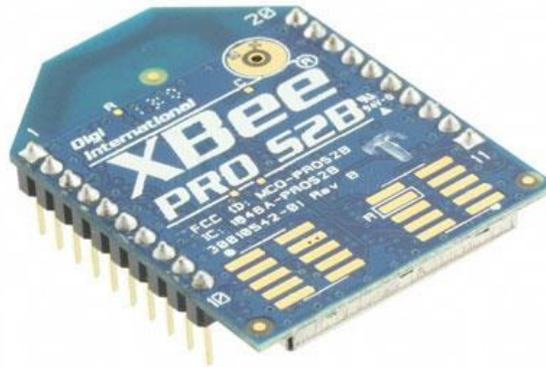
Fig 2.3.1: Zigbee module
